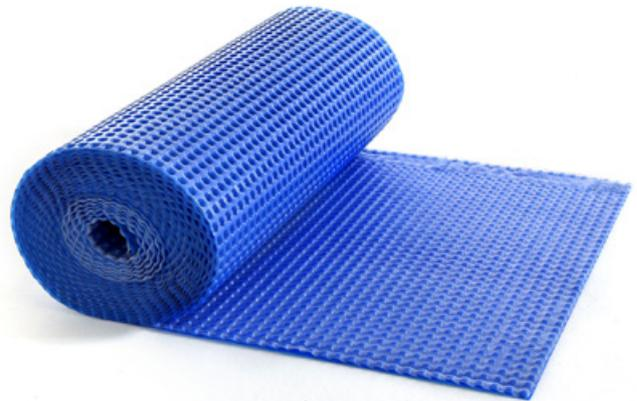
Дренажный мат ТК-NET – это геокомпозит, выполненный из полиэтилена высокой плотности с термически прикрепленной сеткой. Дренажный мат ТК-NET укладывают на гидроизолированную бетонную плиту, чтобы обеспечить быстрое отведение воды из-под мощения. Техническое описание мата ТК-NET можно посмотреть на нашем сайте:
