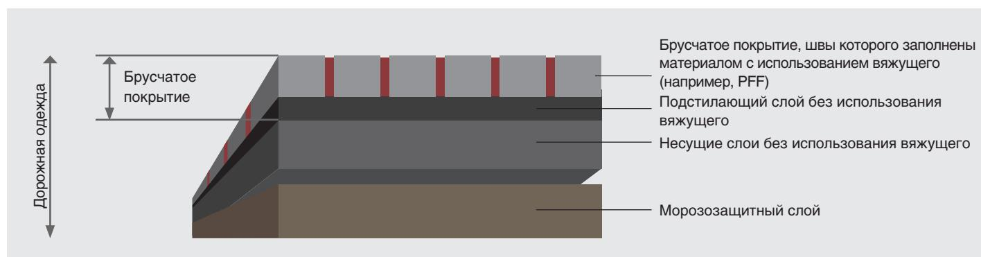
**Смешанная конструкция с подстилающим слоем с использованием вяжущих:**
