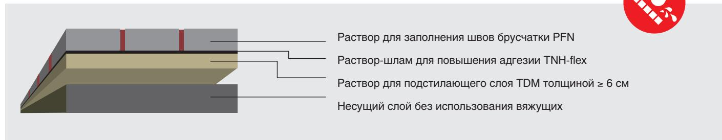
Покрытия из многоугольных плит из бетона или природного камня, водонепроницаемые
