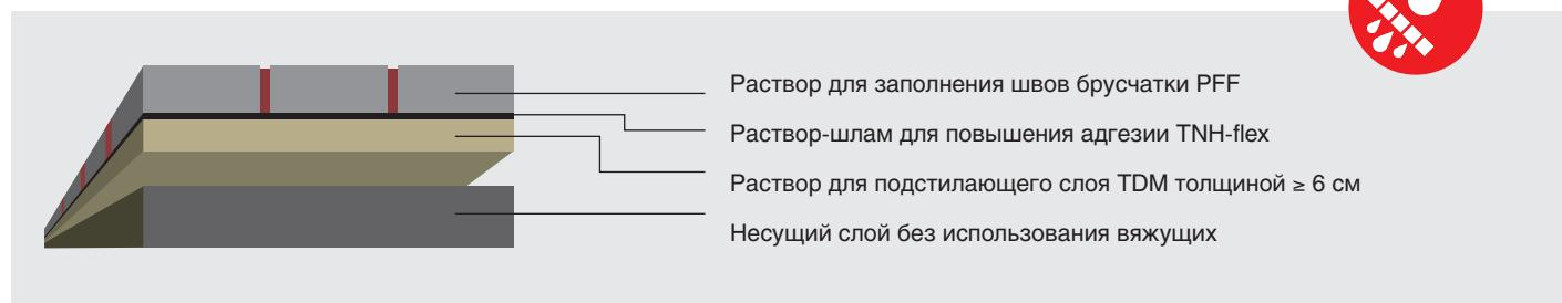
Плиточные покрытия из бетона или природного камня, водонепроницаемые
