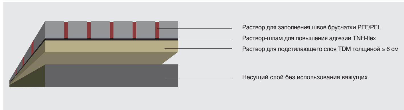
Нагрузка от легкового транспорта весом до 3,5 т (например, въезды, N2 согласно ZTV Wegebau)
