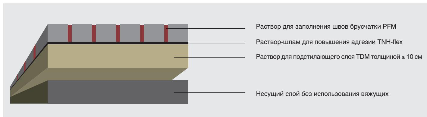
Нагрузка от легкового транспорта, периодически допускается нагрузка до 20 т (например, въезды, N3 согласно ZTV Wegebau)
