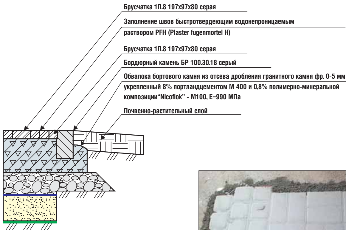
Рис. 35а. Конструкция дорожной одежды вертолетной площадки
