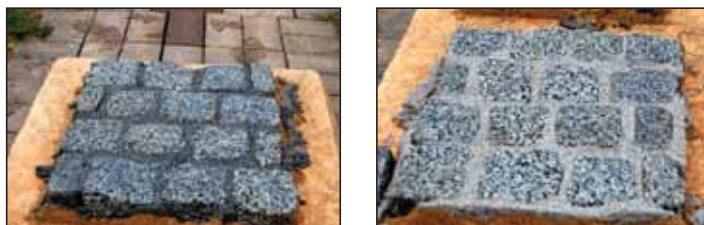
Рис. 14. в. Перед применением растворов на всей площади мощения рекомендуется сделать опытный участок
